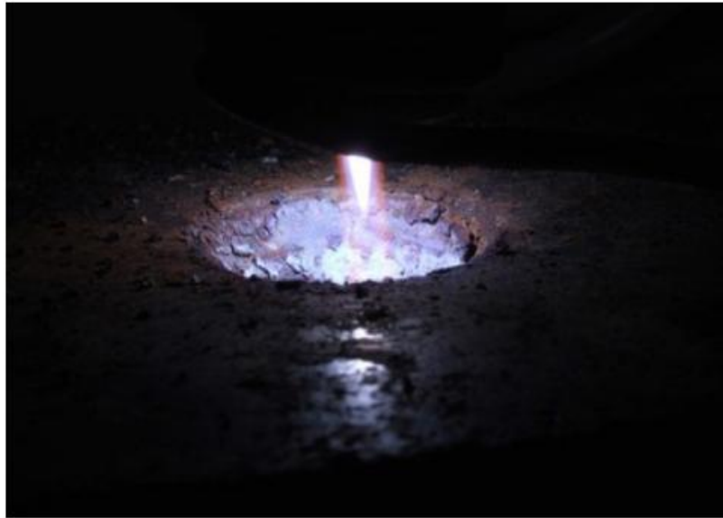
Figura 6 Destrucción de Materiales con Plasma Térmico.
