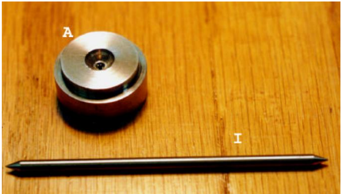
Figura 28 Electrodo de la Antorcha de Plasma propuesta a nivel experimental.
