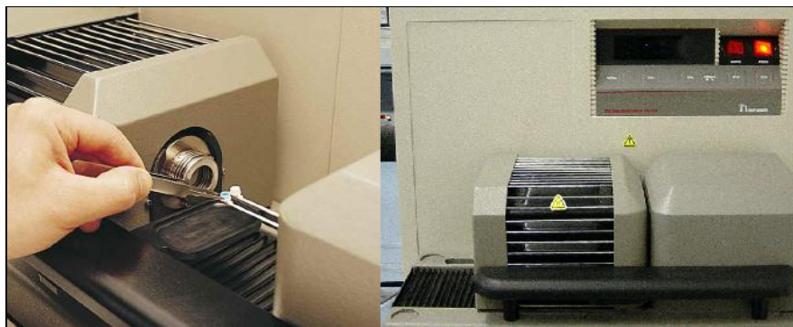
Figura 3.1.- Termobalanza TA Instruments SDT 2960 con DSC-TGA simultáneos.
