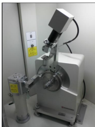
Figura 3.2.- Difractómetro de rayos x Shimadzu XRD 6000 con ánodo de cobre y geometría de Bragg-Brentano.
