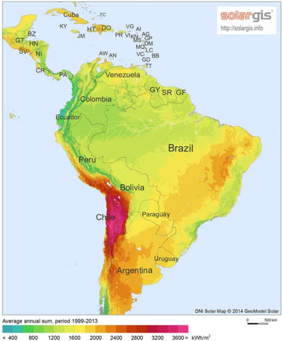
Figura 1.6: Mapa de radiación solar directa normal de Sudamérica, en el que se aprecia un alto nivel de radiación solar a lo largo del año en el norte de Chile, donde se concentra el mayor número de proyectos de generación fotovoltaica [5].
