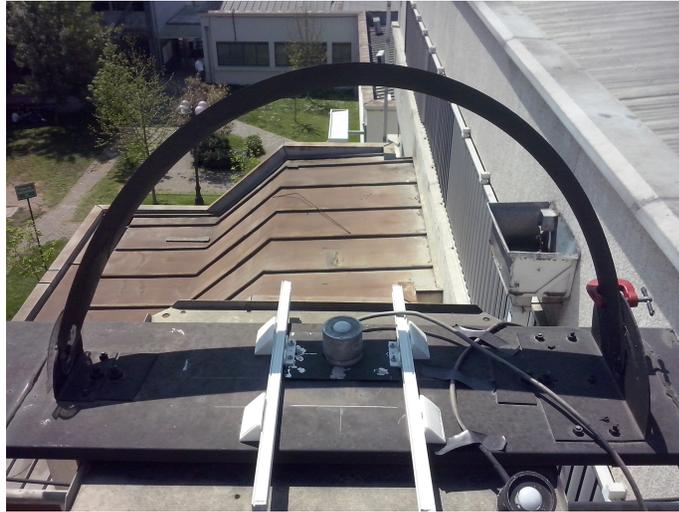
Figura 2.13: Banda de sombra y un riel para variar la posición del piranómetro.
