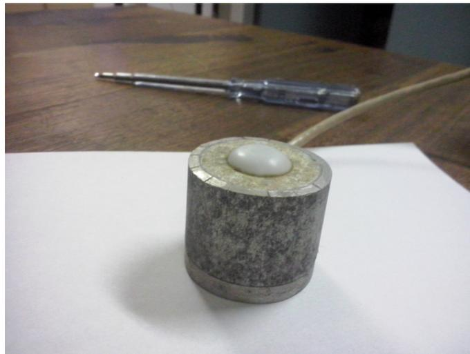
Figura 2.11: Piranómetro finalizado, visión externa.
