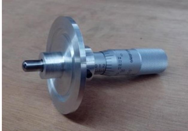
*Figura 3. 4: Imagen del soporte fabricado para el micrómetro. El micrómetro se encuentra fijo gracias al uso de tres prisioneros radiales sobre su base de sujeción. El vástago del micrómetro actúa libremente en la cámara.*
