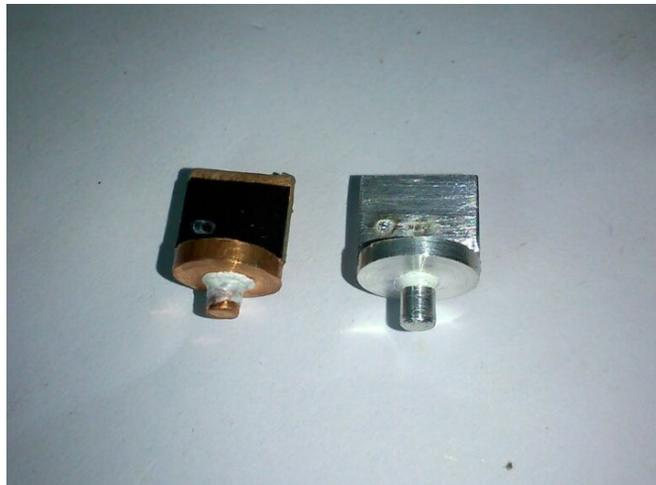
Figura 4.3: Blancos utilizados con el láser de Nd-YAG. A la izquierda, target de Cu con una oblea de Silicio. A la derecha, target de Al. Se puede observar en qué punto golpea el láser y ablaciona el material.
