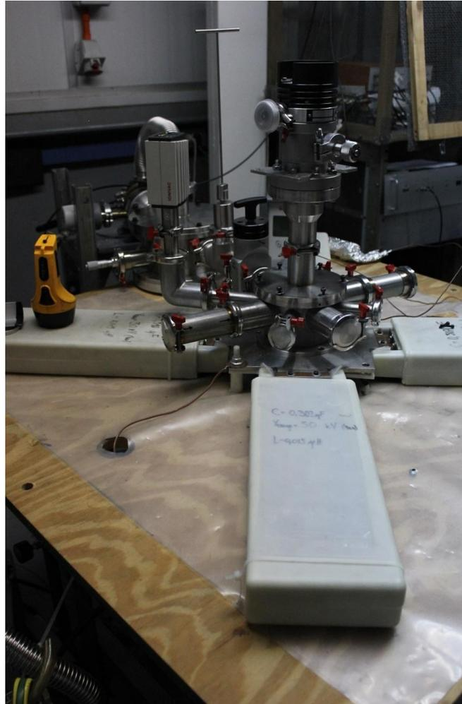
Figura 3. 7: Fotografía del Generador Multipropósito del departamento de plasmas termonucleares (DPTN) de la CCHEN. Se observa la disposición horizontal de los cuatro condensadores de  $0,3 \text{ } [\mu\text{F}]$  alrededor de la cámara de descarga.
