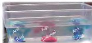
Figura 4.2, experimento mostrativo corrientes convectivas
