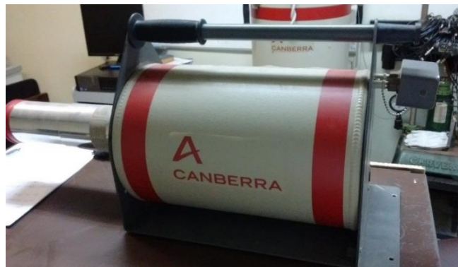
Figura 16: Detector a utilizar en la medición de actividad de elementos combustibles quemados.
