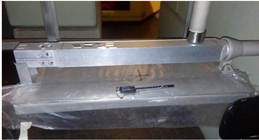
Figura 26: Elemento LRF-06 montado en mesa de muestreo para pruebas de alineación.
