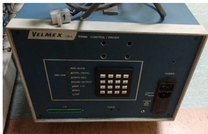
Figura 44: Panel frontal del controlador de motores asociado a M1 y M2.
