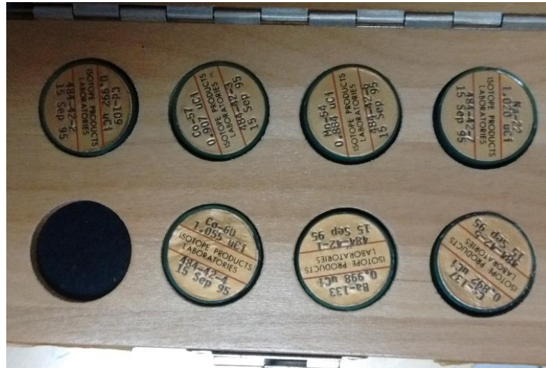
Figura 88: Kit de patrones en forma de disco del que se usaron para la calibración en energía las fuentes de Cs-137, Co-60 y Ba-133.
