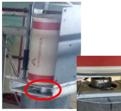
Figura 65: Lugar del montaje donde fueron colocados los patrones para esta calibración.
