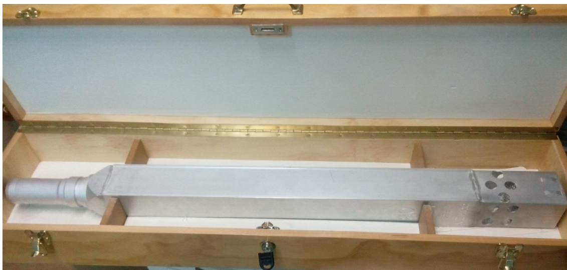
Figura 9: Elemento combustible falso LRF-06 utilizado en pruebas del montaje en el RECH-1.
