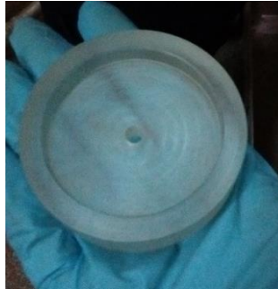
Figura 81: Tapa acrílica usada como apoyo en la alineación del tubo.
