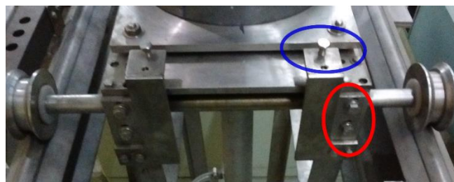
Figura 80: Encerrado en rojo, pernos que fijan el soporte del tubo seco al carro; en azul, perno que permite regular la posición de dicha estructura.
