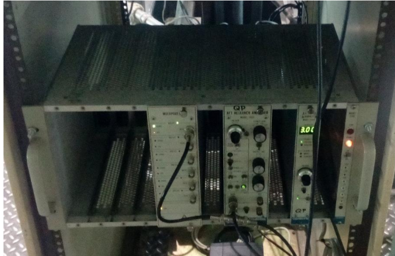
Figura 18: NIM BIN con módulos de conjunto de espectrometría utilizados. De derecha a izquierda: Fuente HVDC 3106D, Amp 2025 y MPIO.
