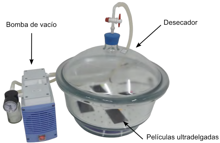
Figura 2.7: Cámara de vacío, donde las películas fabricadas son sometidas a vacío para la extracción de solvente.
