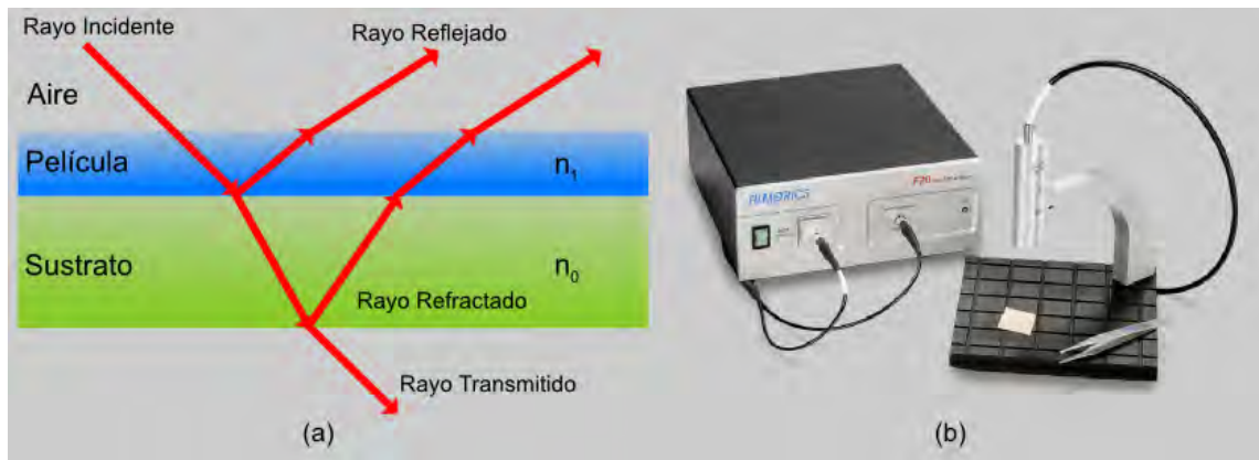
Figura 2.8: Reflectancia espectral. (a) Fenómeno de reflexión, refracción y transmisión de la luz al pasar por diferentes medios. (b) Equipo Filmetrics F20.
