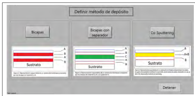
Figura A.1: Interfaz de usuario que permite controlar el sputtering para preparar muestras con bicapas, bicapas con separador y co-sputtering .
