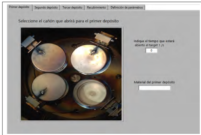
Figura A.2: Interfaz de usuario donde se ingresan los parámetros para la fabricación de las muestras mediante bicapas y co-sputtering .
