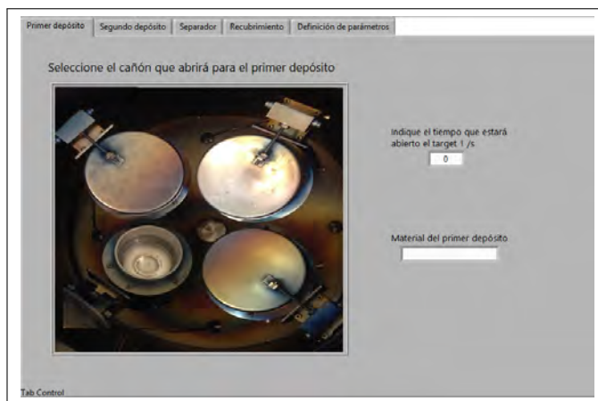
Figura A.4: Interfaz de usuario donde se ingresan los parámetros para la fabricación de las muestras mediante bicapas con separador.
